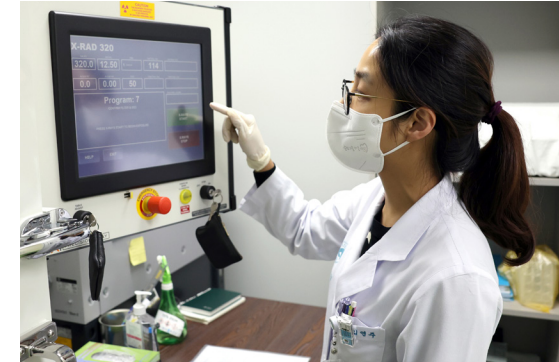
김연주 조교수가 방사선조사장비의 조사에너지, 시간 및 방사선원과 조사될 시료까지의 거리 등을 설정하고 있다.
